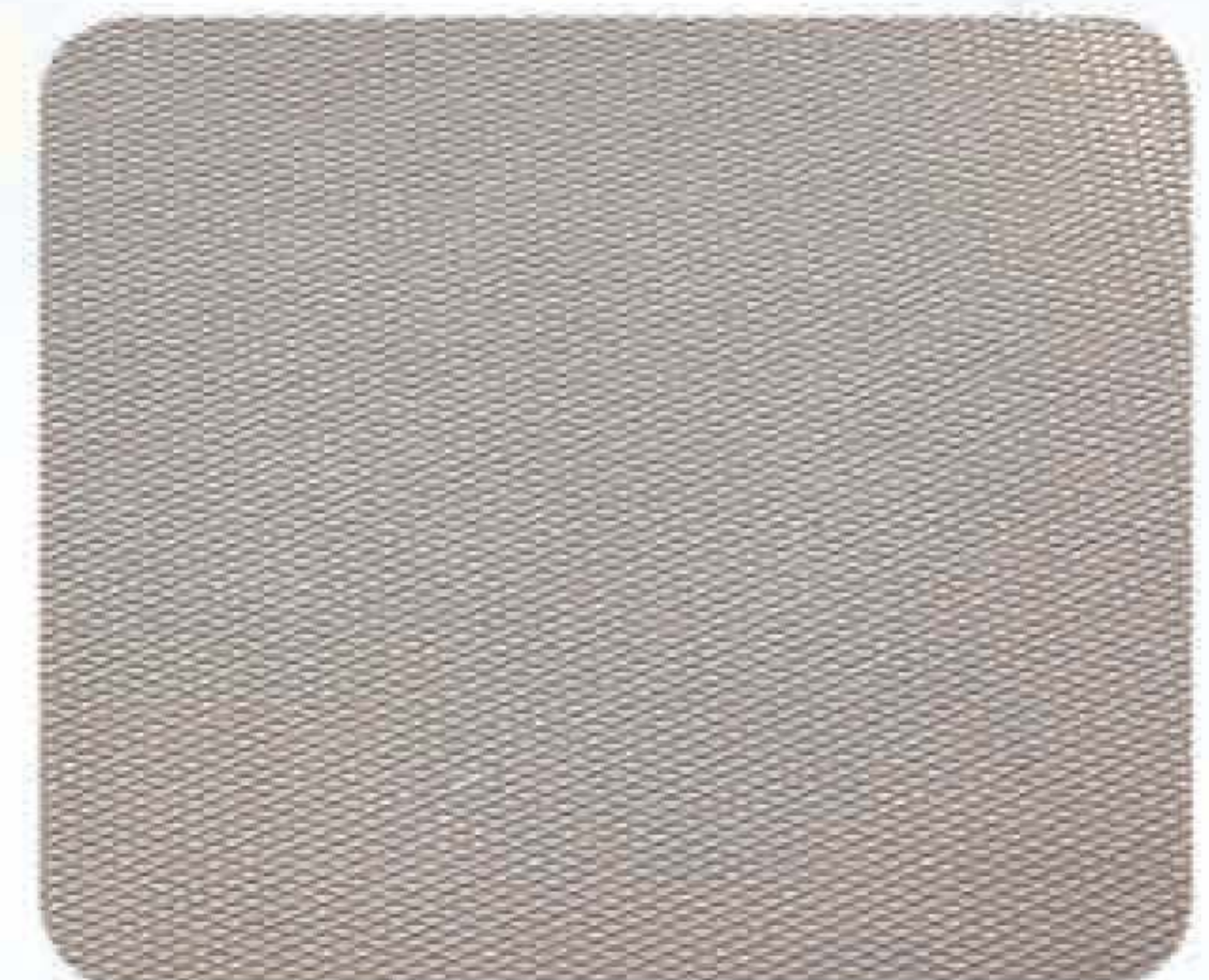
PVC土工膜 PVC geomembrane
